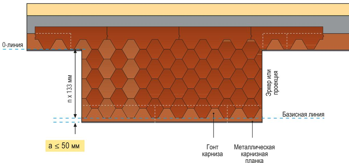
В поперечном направлении карнизные листы не обязательно устанавливают на краю крыши эркера и карниза соответствующим образом. Для типов KL, Jazy, Katrilli, Foxu и 3T поперечное смещение может составлять  $1/6$  длины гонта (то есть,  $166 \text{ мм}$ ), а для гонтов Rocky -  $83 \text{ мм}$ , Ambient -  $345 \text{ мм}$ , для гонтов Mansion - не менее  $150 \text{ мм}$  (для Mansion лучше всего смещение делать разное для разных рядов - от  $150 \text{ мм}$  до  $350 \text{ мм}$ ).
