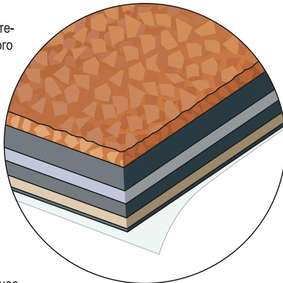
**Оборотная сторона** гонта состоит из защищенного пленкой самоклеящегося битумного слоя снизу (область фигурных вырезов) и области посыпанной мелким песком вверху гонта черепицы. Самоклеющийся слой в нижней части гонта с внутренней стороны позволяет надежно соединять и фиксировать гонты между собой, формируя водонепроницаемое сплошное кровельное покрытие.
